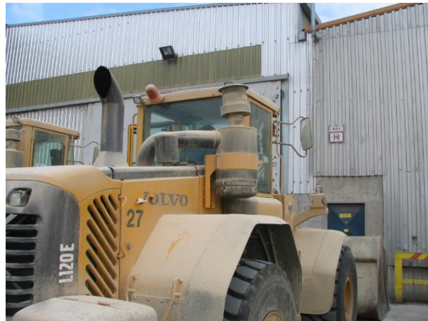
Slika 2: Pravilna postavitev filtra – TAKO NAJ BO POSTAVLJEN
