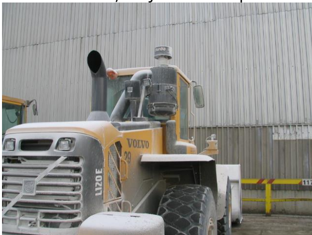
Napačna postavitev filtra.
