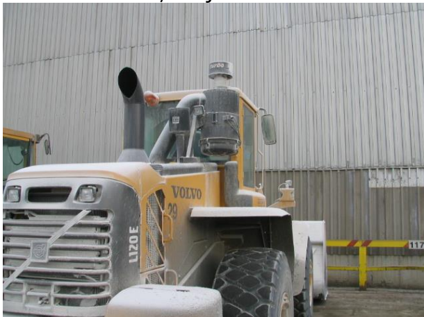
Slika 1: Napačna postavitev filtra.
